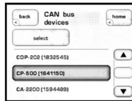
选择CAN总线装置屏幕上的一台设备，将其设为**目标设备**。目标设备的前面板LED显示屏幕将开始闪烁（除非您选择的设备是您用于访问CAN总线的设备）。
