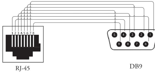
注意：用于 RJ-45 后面板上的连接器和插座的 Cat 5 电线及连接器必须使用针脚到针脚接线方式。
