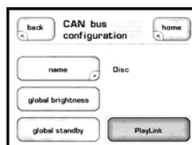
选择好输入后，按**back**（返回）键，然后选择**configuration**（配置）。通过CAN总线配置屏幕上的PlayLink图标启用和禁用PlayLink。
