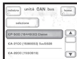
Le fait de mettre en surbrillance la ligne correspondant à un de ces appareils le désigne comme **l'appareil cible**. Les diodes de cet appareil se mettent alors à clignoter (sauf s'il s'agit de l'appareil dont vous utilisez l'écran pour ces réglages).
