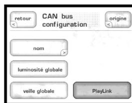
Une fois que vous avez sélectionné l'entrée, pressez la touche **retour (back)** puis choisissez **configuration**. La fonction PlayLink est alors activée et apparaît sous forme d'icône dans le menu de configuration CAN-Bus.
