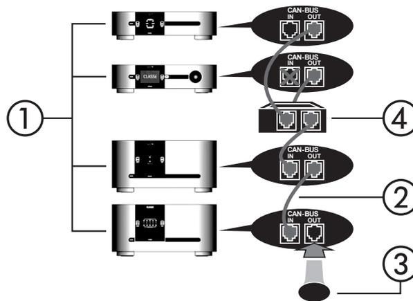
NOTE : la chaîne ainsi formée peut nécessiter la présence d'un bouchon de terminaison CAN-Bus sur la prise de sortie CAN-Bus du dernier appareil.
