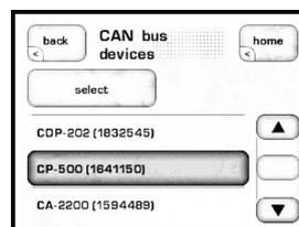
选择CAN总路线装置屏幕上的一台设备，将其设为**目标设备**。目标设备的前面板LED显示屏幕将开始闪烁（除非您选择的设备是您用于访问CAN总线的设备）。
