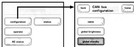
**配置** 选择 **configuration**（配置）按钮会出现 **CAN-Bus configuration**（CAN总线配置）屏幕，您可以从该屏幕上进入名称、全局亮度和全局待机功能。
