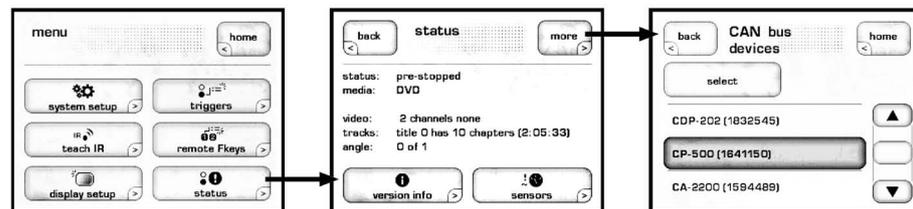
这时，触摸屏会显示**CAN-Bus devices**（CAN总线装置）屏幕，屏幕按机型和序列号列出已经连接的Delta系列设备。
