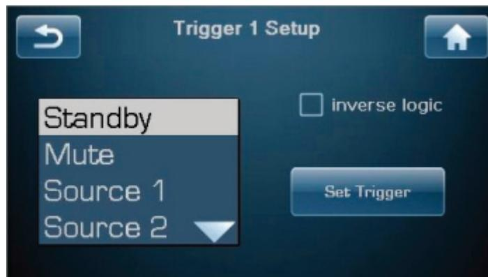
Запускающие сигналы могут быть связаны с ждущим режимом Standby, конкретным входом или конфигурацией. Чтобы использовать настройку Inverse Logic (обратная логика), просто выделите кнопку Inverse Logic на странице настройки Triggers.
