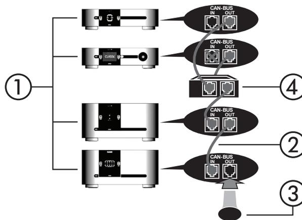
NOTE : la chaîne ainsi formée nécessite la présence d'un bouchon de terminaison CAN-Bus sur la prise de sortie CAN-Bus du dernier appareil.
