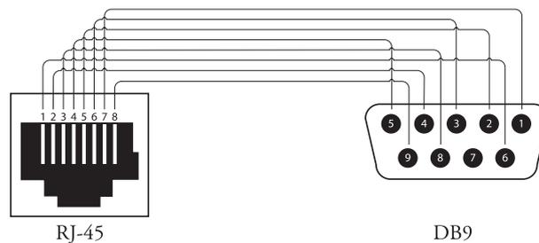
Remarque : le câble Cat 5 et le connecteur qui est utilisé pour réaliser l'adaptateur et vient se brancher dans la prise RJ-45 à l'arrière doivent permettre le câblage « fil à fil ».
