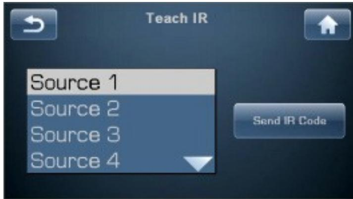
Teach IR (学习红外) 页面显示了 Sigma SSP 上可用的红外代码的滚动列表。滚动到您希望带宏命令功能的遥控器学习的命令, 再轻触 **Send IR Code** (发送红外代码) 键。Sigma SSP 通过前面板持续发送该命令代码 - 只要您一直按住该键不放 - 直到您的第三方遥控器已经学习了该代码。
