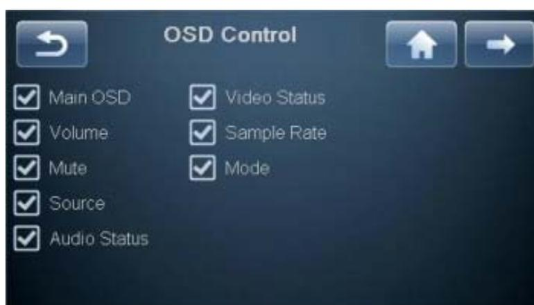
临时 OSD 图象的位置可根据不同视频分辨率和屏幕长宽比进行调节。如：2.35:1 屏幕显示 1080p 信号时，OSD 图象就有可能部分处于屏幕下方以外，此时可使用 OSD Shift（OSD 移动）功能进行调节。进入 OSD Shift（OSD 移动）页面（在 OSD Control（OSD 控制）页面上按 more 箭头）后，你可以在垂直方向上将 OSD 图象移动 15 个像素。按下 save（保存）保存当前视频信号分辨率下的设置。如想把 OSD 移动到屏幕顶端，可以通过步进把 OSD 移动到顶部边缘（6 步）。按 save（保存），把 OSD 从当前位置再次步进抬高，当到达所需位置后再按 save（保存）。
