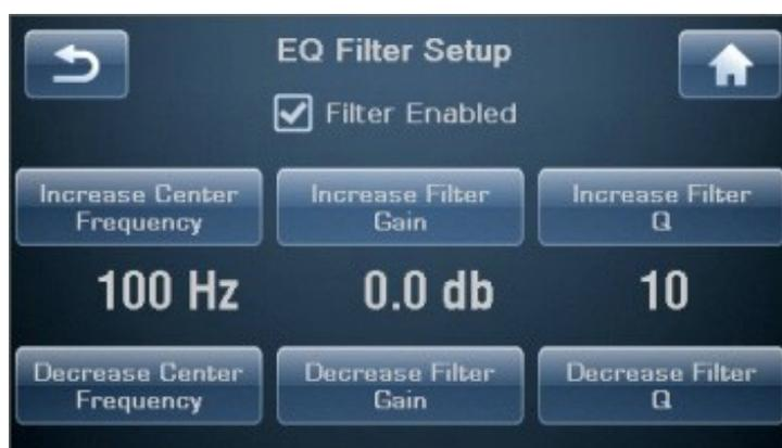
您不需要启用每个通道的所有或者任何滤波器。安装人员只需要对必要的通道进行调节，以针对房间的相互作用进行纠正。我们鼓励您咨询Classé经销商，对参数均衡功能进行适当的校准。
