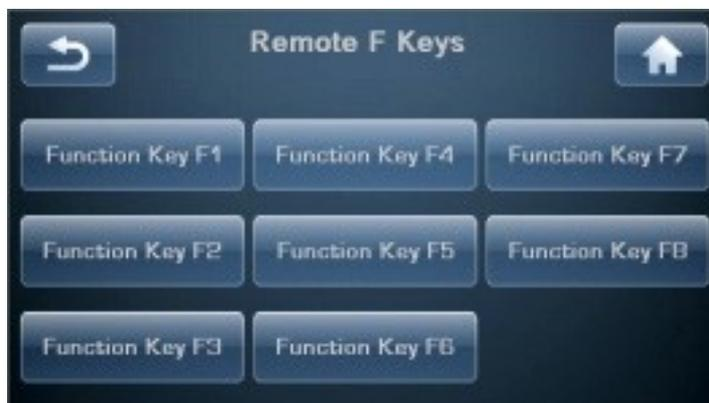
遥控器上的F1至F3键对应于触摸屏上显示的功能键。选择您想分配的功能键，再滚动清单，选择您希望该功能键执行的具体功能。尽管Sigma SSP遥控器仅有三个功能键，但它可以回应多达八个功能键指令。其他Classé遥控器或售后学习遥控器可以发出这些额外的指令。
