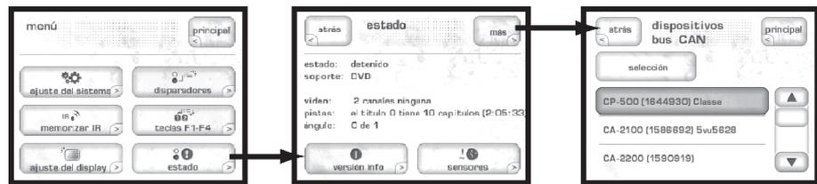
A continuación, la pantalla táctil mostrará la pantalla dedicada a los **dispositivos Bus CAN** (“**CAN-Bus devices**”) en la que figura una lista con el nombre y el número de serie de los componentes conectados.
