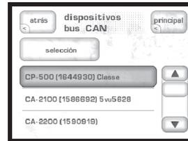
La selección de un componente en la pantalla de dispositivos conectados mediante el Bus CAN lo identifica como el **componente de control** (“**target unit**”). En ese momento, los indicadores luminosos del panel frontal de dicho componente empezarán a parpadear (a menos que usted seleccione el aparato que está utilizando para acceder al Bus CAN).
