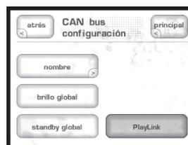
Una vez que haya seleccionado la entrada, pulse **atrás** (“**back**”) y a continuación seleccione **configuración** (“**configuration**”). La función PlayLink se activará y desactivará desde el icono PlayLink de la pantalla de configuración correspondiente al Bus CAN.
