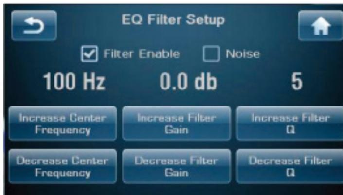
Usted no necesita tener todos o incluso alguno de los filtros definidos para cada canal. El instalador sólo necesita realizar los ajustes correspondientes a los canales necesarios para corregir el problema acústico detectado. *Le animamos a que contacte con su distribuidor Classé autorizado con el fin de calibrar adecuadamente la función de Ecuación Paramétrica del Sigma SSP MkII.*
